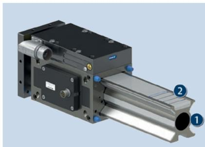
Линейные прямые оси промышленной серии LDx (на рисунке показан линейный модуль LDN) включают в себя скользящую плиту со встроенным первичным элементом двигателя и измерительной системой. Вторичный элемент состоит из постоянных магнитов, встроенных в профиль линейной оси.
