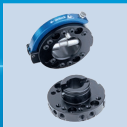
Система ручной смены оснастки
