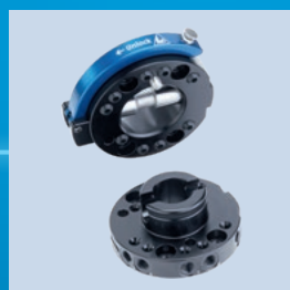
Система ручной смены оснастки
