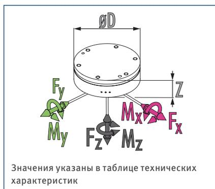
ⓘ Все усилия и моменты, действующие на датчик, должны находиться в указанном диапазоне измерений. Расширение диапазона измерения снизит количество циклов нагрузки и может привести к выходу датчика из строя. При необходимости расширения диапазона измерения обратитесь к нам.
