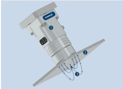
Датчик присутствия обнаруживает наличие детали. После намагничивания внутренний датчик измеряет изменение магнитного поля. Если соответствующее пороговое значение превышено, это говорит о присутствии заготовки.
