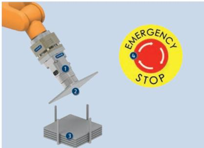
Магнитный захват EMH обеспечивает безопасную и надежную работу. Полярность постоянных магнитов меняется посредством подачи короткого импульса тока, при этом магнитный захват остается в текущем состоянии даже в случае сбоя питания или аварийного останова.
