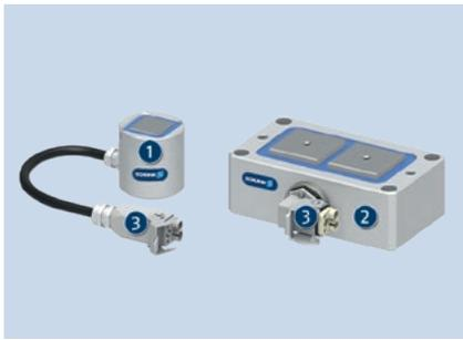
Магнитные захваты EGM непосредственно оснащены штекерными разъемами. На магнитных однополюсных захватах (EGM-M) эти соединители присоединены к захвату с помощью соединительного кабеля. Это обеспечивает гибкую прокладку. На двухполюсных захватах EGM-B штекерные разъемы подключаются к корпусу. Кабельный вывод можно поворачивать с шагом в 90°.
